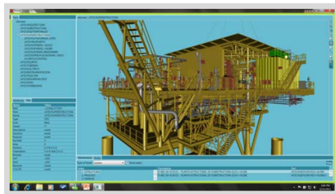
Maintenance de plate-forme, traçabilité de pièces
